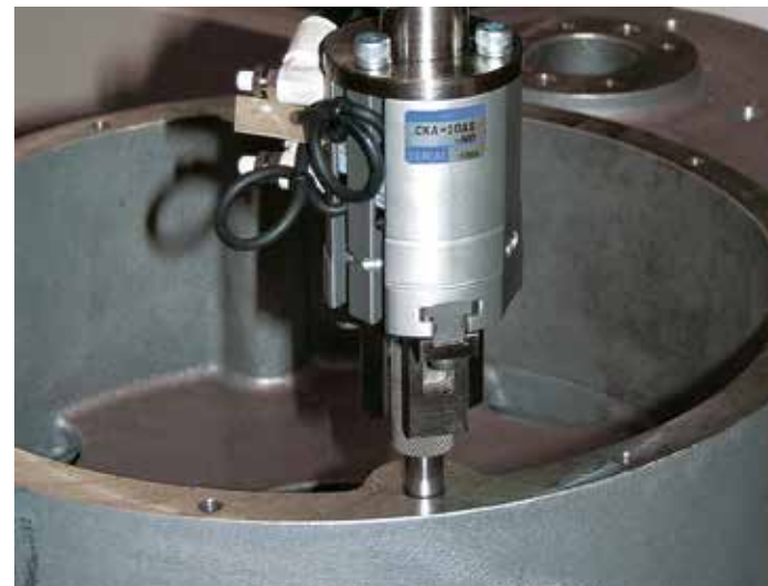
Maßkontrolle von Bohrungen (Eindrehen des Lehrdorns durch Kraftregelung)
