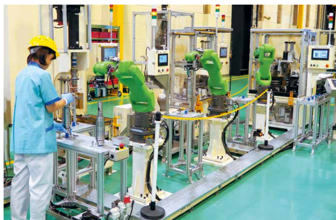
主軸の組立て Assembly of spindles
